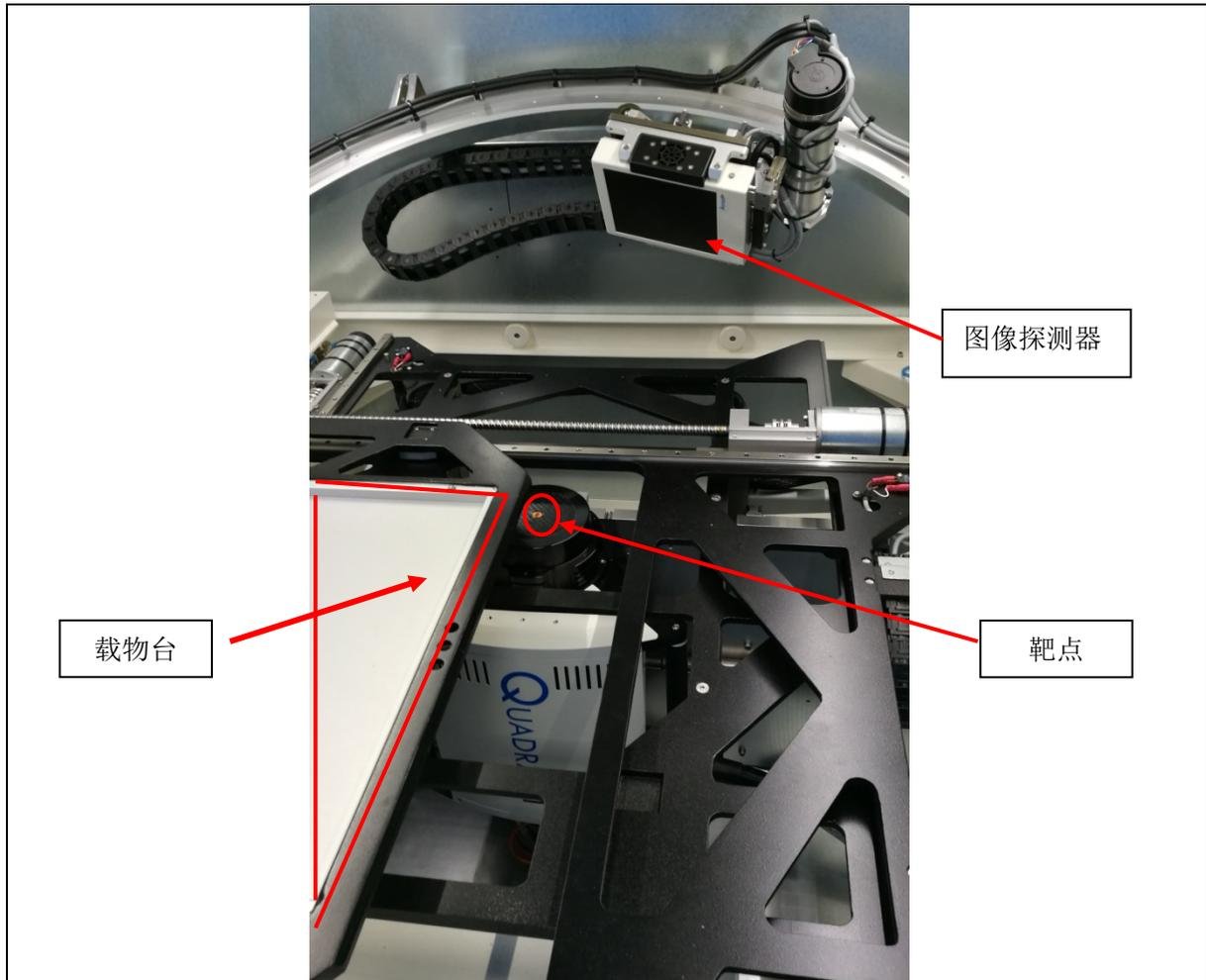
图 9-3 拟购置 X 射线 3D 检测仪内部图
